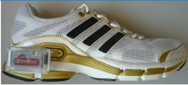
Abb. 1 ◀ Zur Datenaufzeichnung wurden die Biosensoren ausgestattet mit Gyroskopen, Akzelerometern und Bluetooth® zur drahtlosen Datenübertragung an den adidas_1 Sportschuh angebracht
